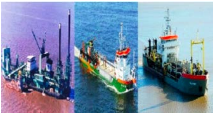
Figura 10. Draga cortador amazone /Draga de succión por arrastre/Draga de S. autopropulsada. Fuente: www.histarmar.com.ar/
