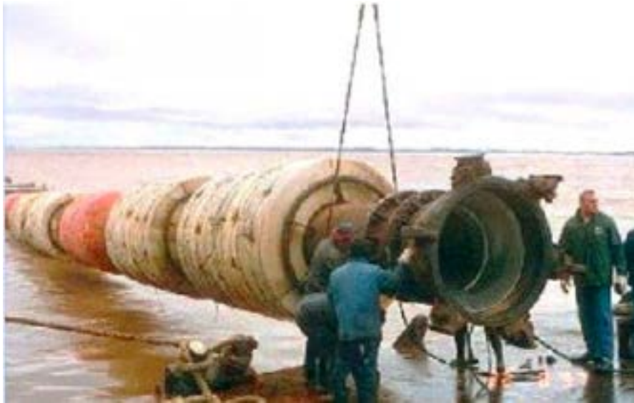
Figura 11. Trepano Draga Amazon / Boyas de los veriles del canal Martín García/ Cañería flotante de descarga del refulado. Fuente: www.histarmar.com.ar/
